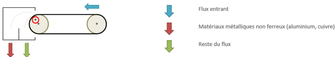
Figure 12 : Schéma de fonctionnement d'un séparateur à courant Foucault
