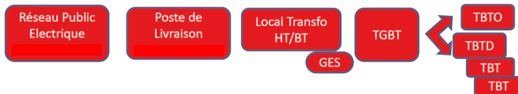
Figure 28 : Schéma de distribution unifilaire d'électricité
