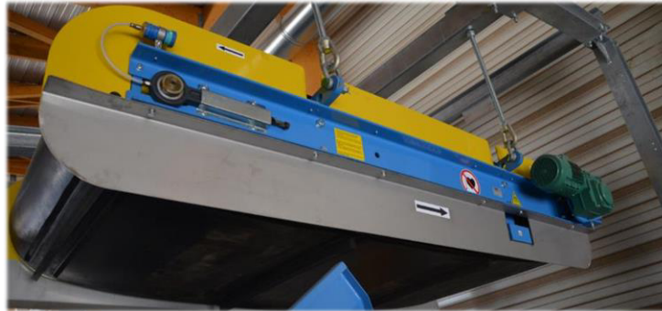
Figure 17 : Photo de principe d'un séparateur magnétique de type overband
