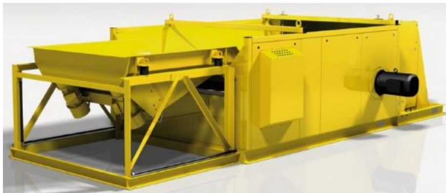
Figure 18 : Photo de principe du séparateur de métaux non ferreux à courant de Foucault
