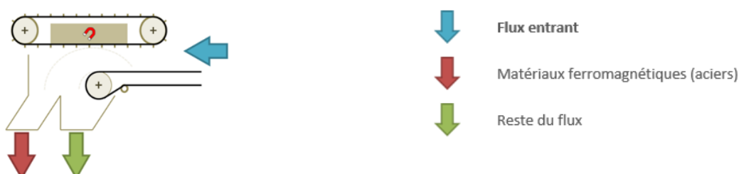
Figure 11 : Schéma de fonctionnement d'un séparateur magnétique Overband
